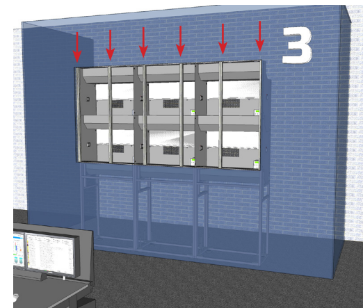
Étape 3 - Installation de la sous-structure du mur LED sur les cubes
