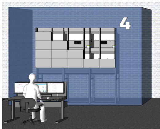
Étape 4 - Installation des cabinets LED
